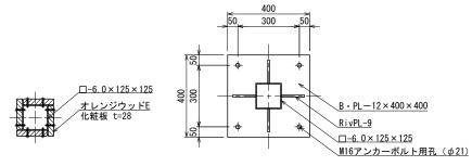
支柱断面図 S=1:10 (A3 S=1:20) ベースプレート詳細図 S=1:10 (A3 S=1:20)
