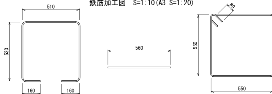
① 上端筋：4-D10 ② 下端筋：8-D10 ③ HOOP筋：4-HOOP D10
