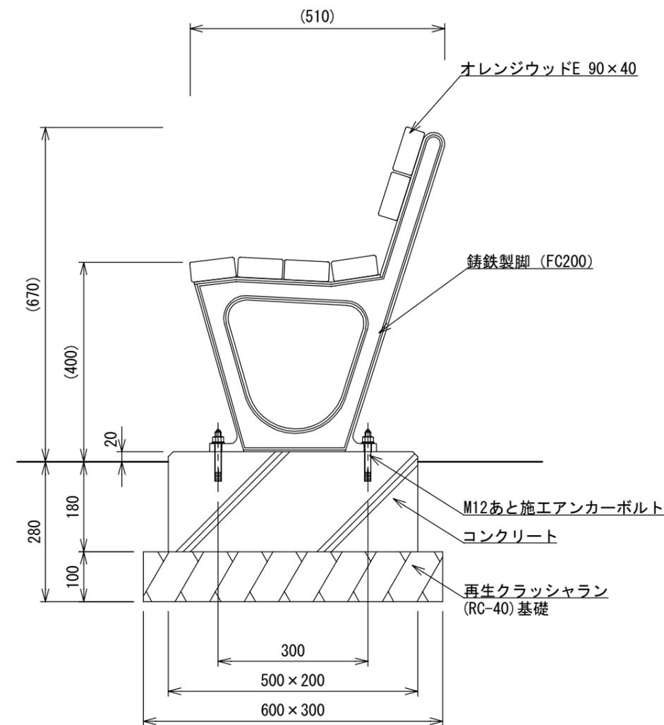
[座部断面図(2層構造)]
