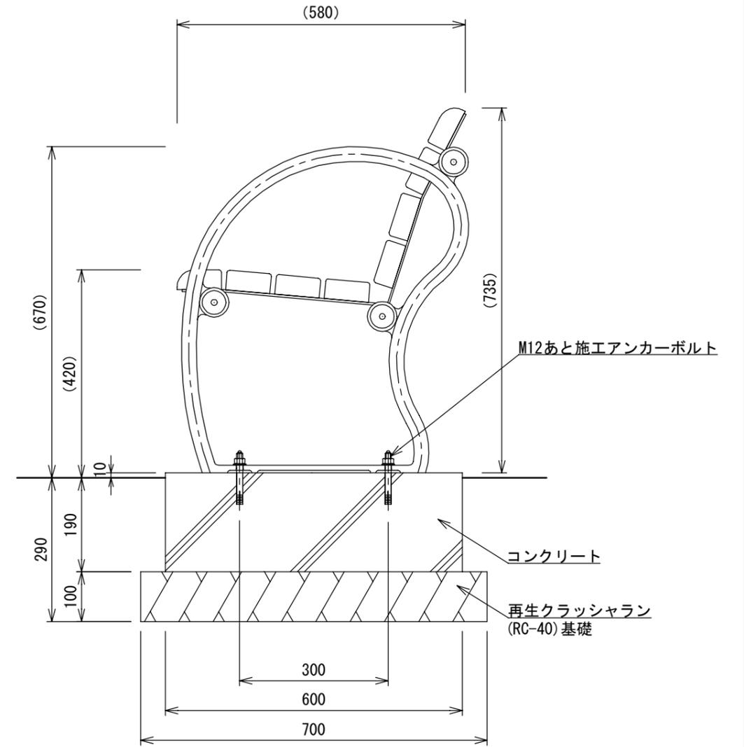
[座部断面図(2層構造)]
