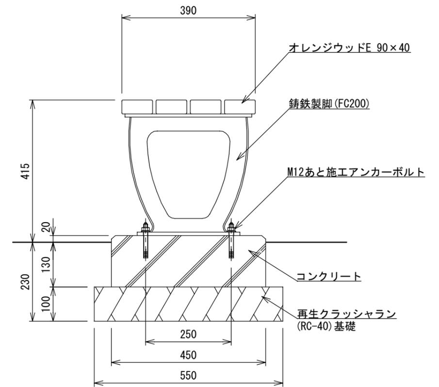
[座部断面図(2層構造)]
