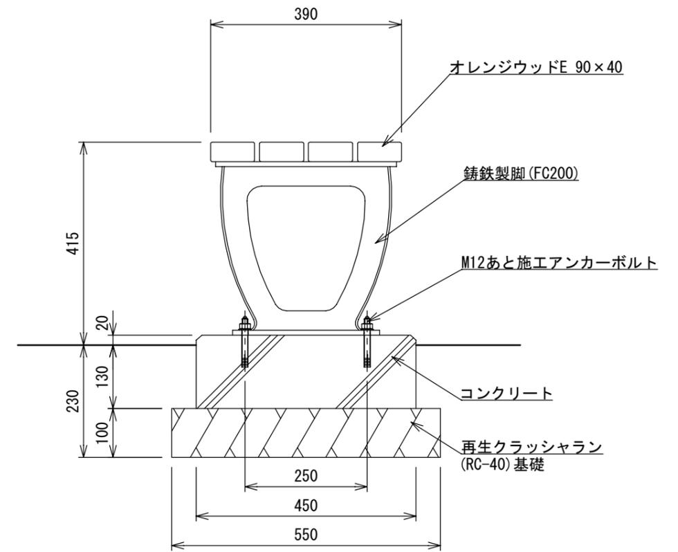
[座部断面図(2層構造)]
